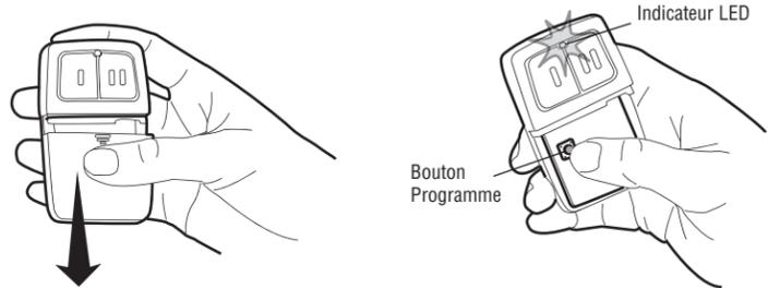
**4** Enfoncer et relâcher le bouton. Lorsque le DEL cesse de clignoter, continuer d'enfoncer et de relâcher le bouton jusqu'à ce qu'un déclic se fasse entendre de l'ouvre-porte de garage, une lampe sur l'ouvre-porte de garage clignote, la porte de garage s'ouvre/se ferme ou un bip retentit de l'actionneur du portail (18 fois au maximum).
